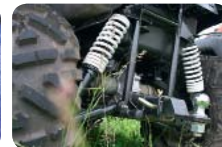
Задняя подвеска независимая, пыльники ШРУСов хорошо защищены
